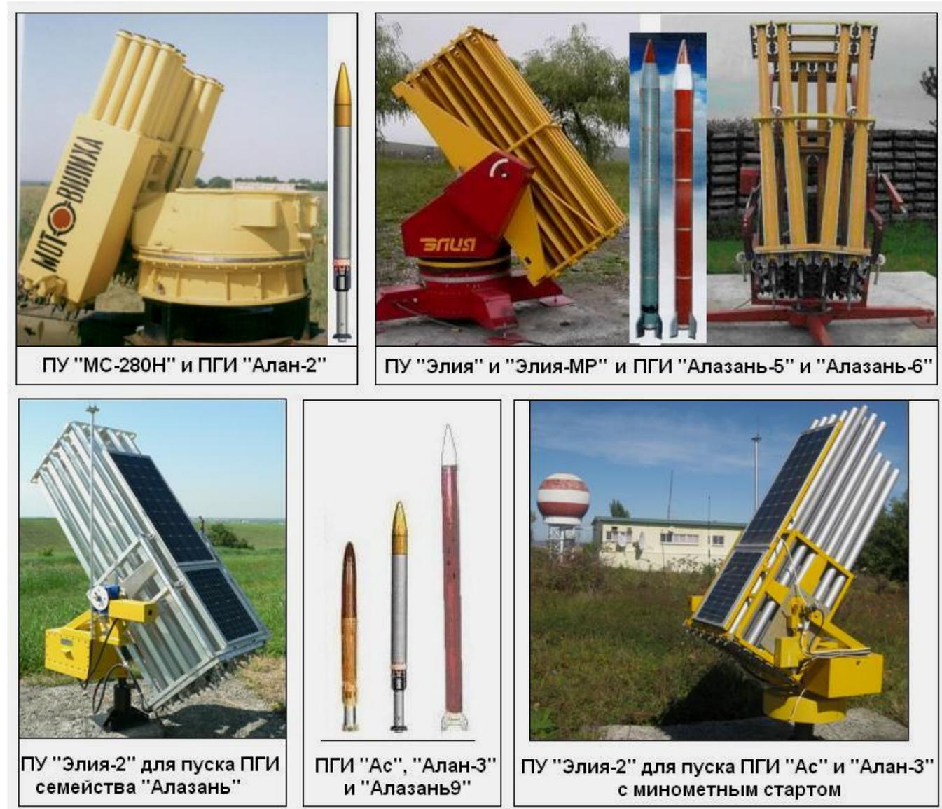
Рис. 13.14 – Ракетные противорадовые комплексы третьего поколения
