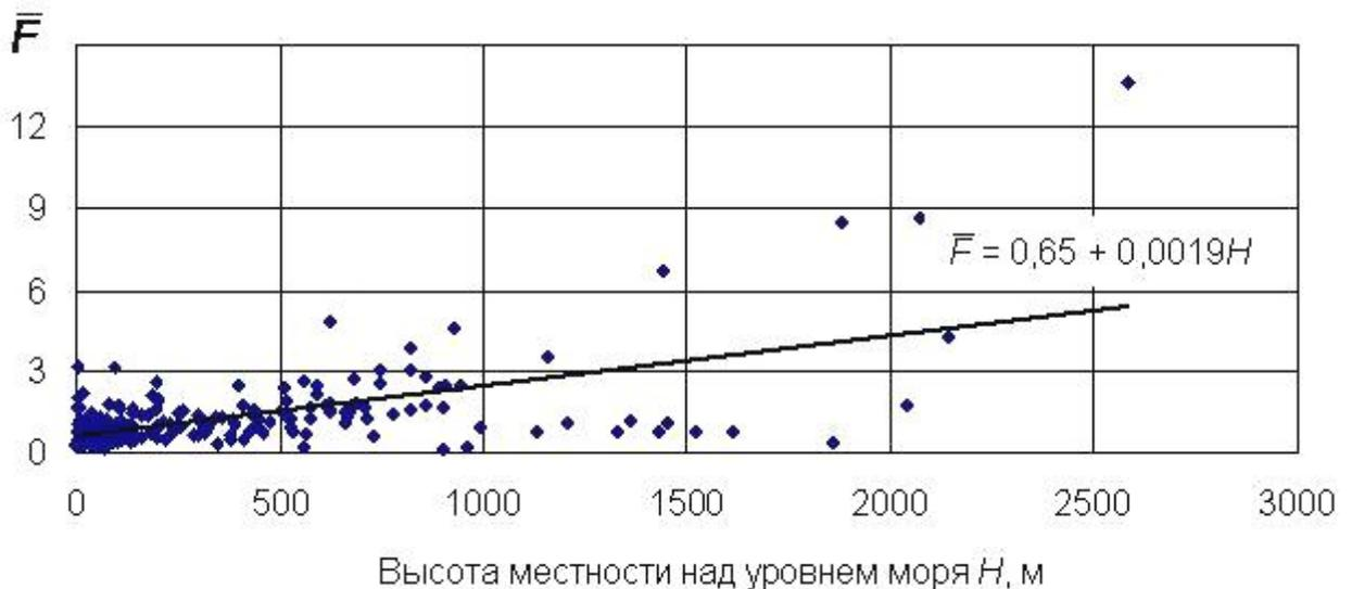
Рис. 5.2 - Зависимость частоты выпадения града от высоты [7]
