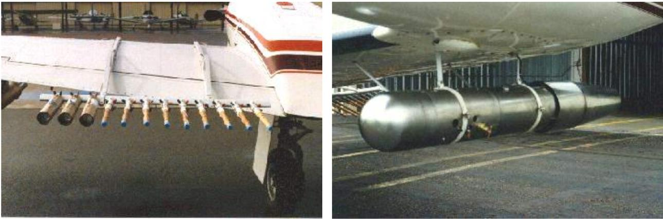
а) пиротехнический генератор; б) ацетоновый генератор
